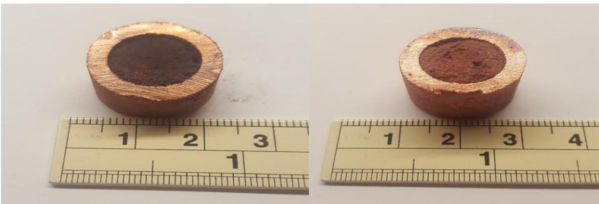
**FIG 7: SPECIMENS TREATED WITH ULTRASONIC AGITATION IN ETHANOL FOR 6 HOURS. LIGHTLY SINTERED POWDER (LEFT) AND HEAVILY SINTERED POWDER (RIGHT).**
