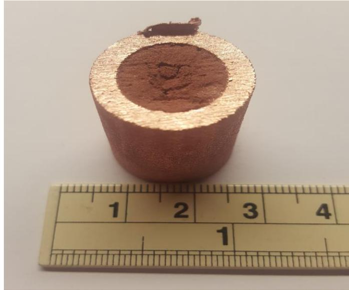
**FIG 5: EXAMPLE OF A SPECIMEN BEFORE ULTRASONIC TREATMENT.**
